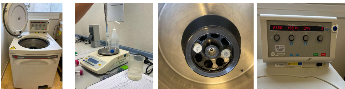
Figura 41: Pesant a la balança les solucions per tal que estgui tot equilibrat i preparant la ultracentrifugadora.
