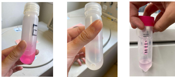
Figura 43: S'observa el "pellet" al fons del tub i el filtre d'ultracentrífuga amb el "pellet" i aigua.
